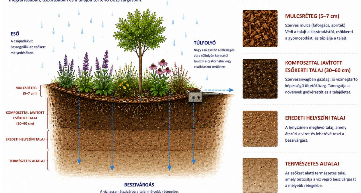
7. ábra Esőkert rétegrendje
