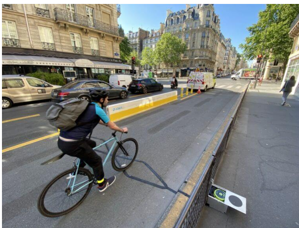
104. ábra: Könnyen telepíthető kerékpáros fogalomszámláló eszköz 136
